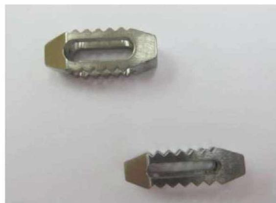
Рисунок 5. – Разработанные межтелевые имплантаты для стабилизации поясничного отдела позвоночника
